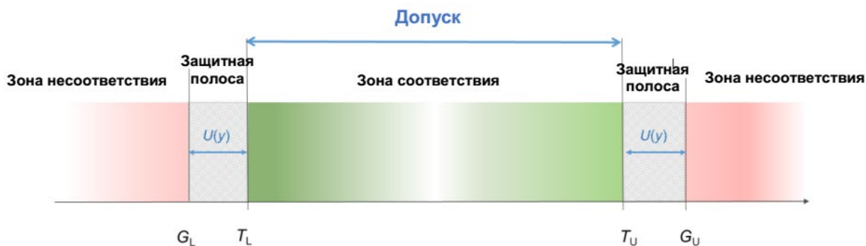
Рисунок 3 – Область допустимых значений в соответствии без установленной защитной полосой
